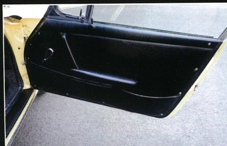
Le bouton d'ouverture de la porte était dissimulé au bout de l'accodoir
